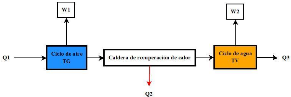
1Figura 1.2.1. Representación esquemática de un ciclo combinado.
